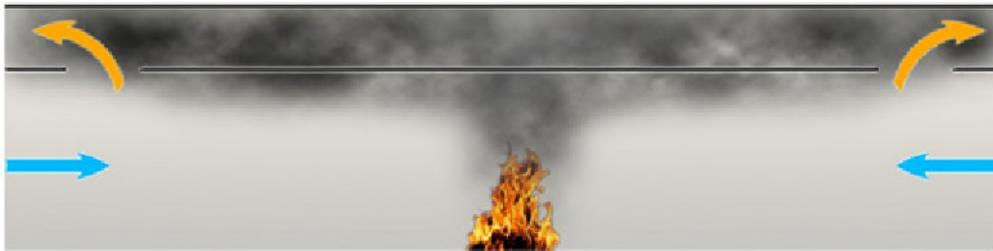
*Ilustración 4. Principio de confinamiento*
